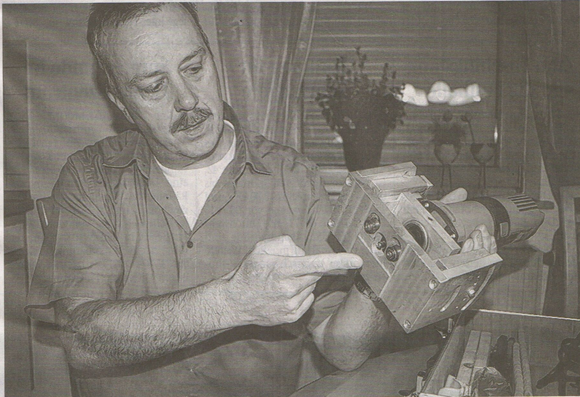
Mit dieser Maschine, die Detlef Wiesner selbst gebaut und entwickelt hat, fräst er die Weltkante in die Skier.
